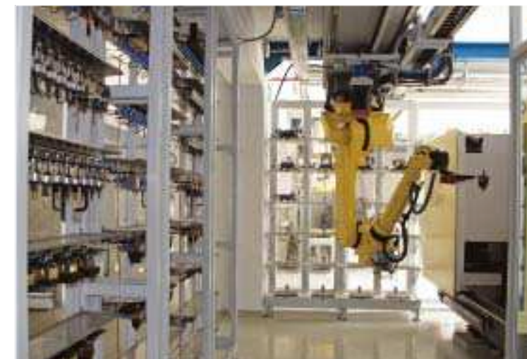
Die automatisierte Elektrodenfertigung hat die Erodierkapazität von Werkzeugbau Ruhla verdoppelt – bei gleichem Personalbedarf Bild: Werkzeugbau Ruhla
