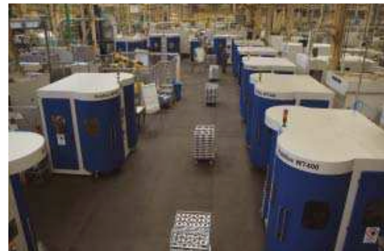
40 verschiedene Zahnräder und Wellen werden in der Getriebefertigung von John Deere in kleinen Losen vollautomatisch hergestellt Bild: John Deere
